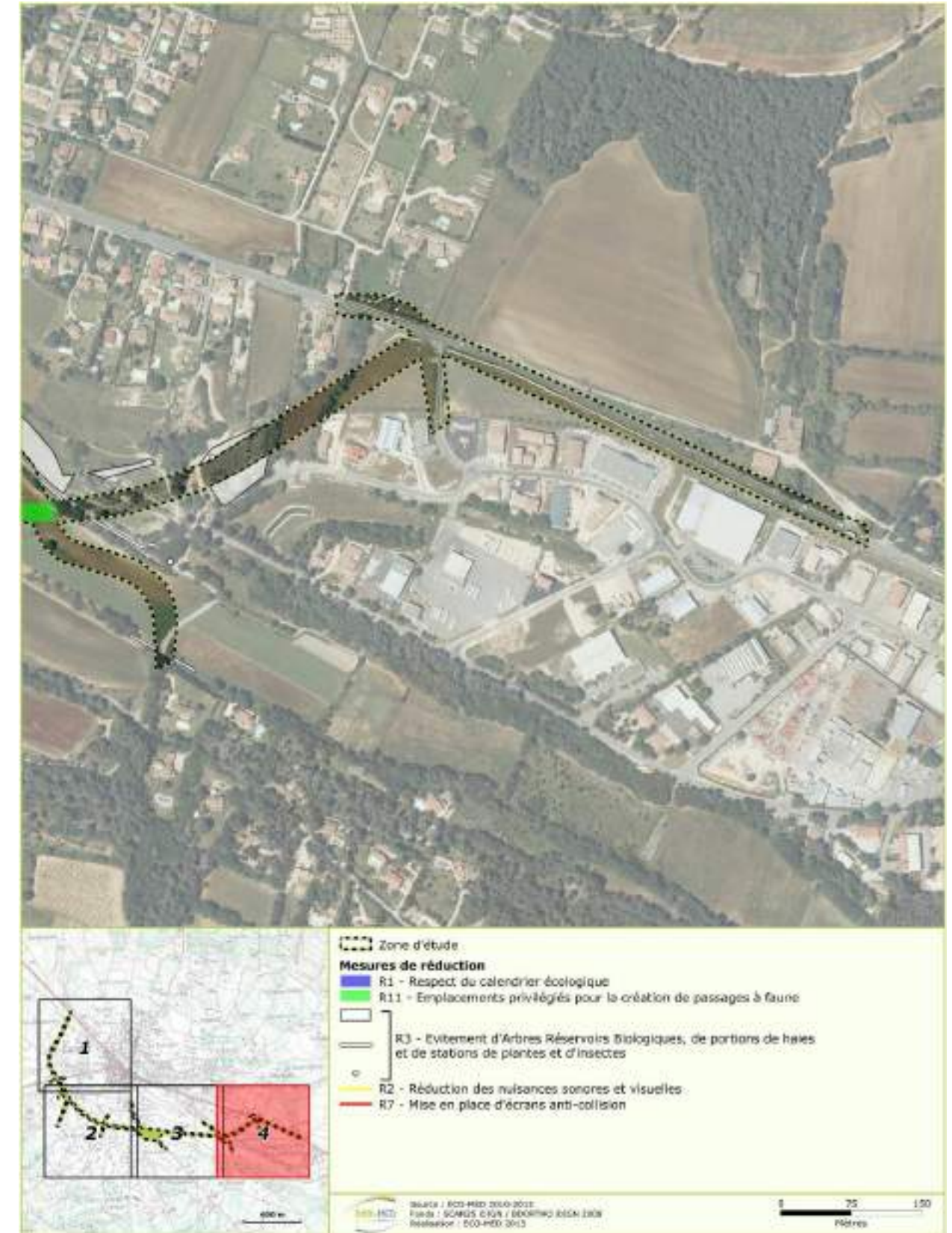
Figure 151 : Mesures de réduction, partie Est du tracé
