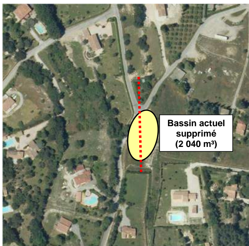
Figure 125 : Bassin de rétention du Deven présent sur l'emprise réservée de la déviation
